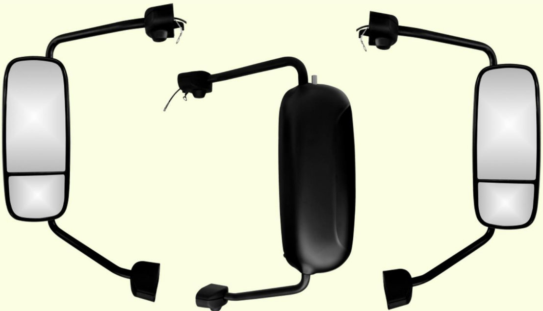
ESPEJO LATERAL PRINCIPAL NEGRO, IZQUIERDO ELECTRICO DESEMPAÑADOR MACK VISION
